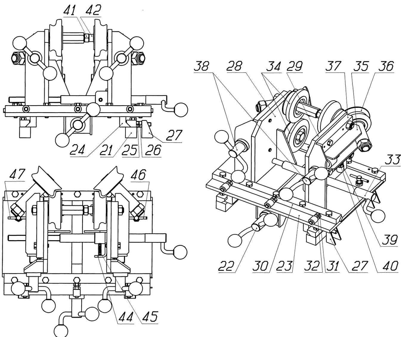
Рисунок 4.2 - Устройство дископравное
