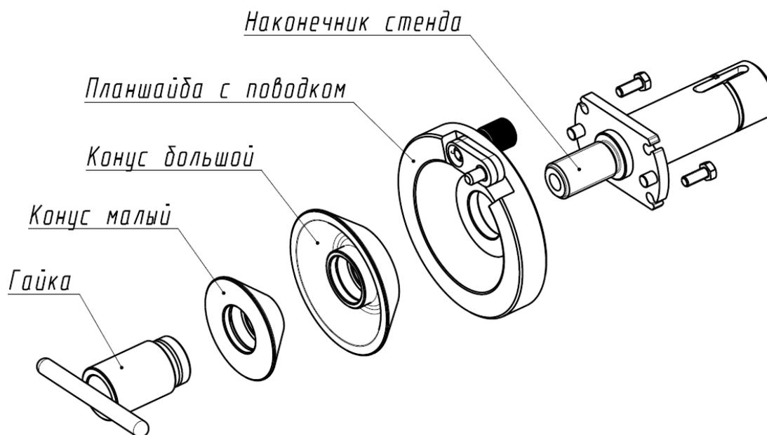
Рисунок 4.3 – Планшайба с поводком, конуса и гайка
