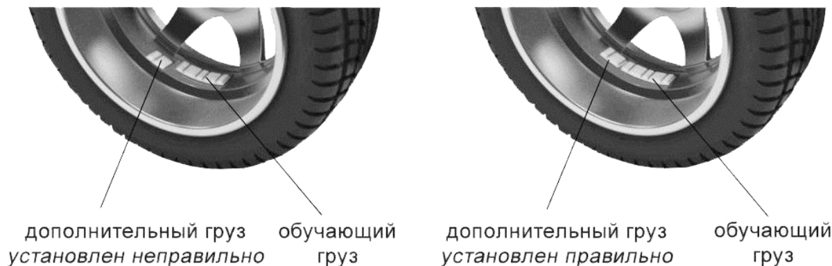
Рисунок 7.2 – Положение дополнительного груза
