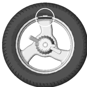
Рисунок 6.3 – Груз установлен в положение «12 часов»
