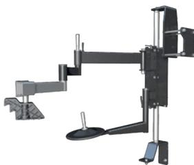
Вспомогательное устройство для работы с низкопрофильными шинами РВ-3
