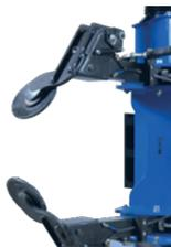
Система отрыва борта с наклонными роликами
