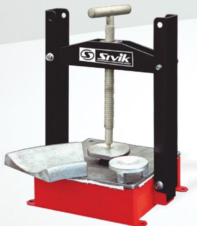
Электровулканизатор для ремонта камер и наружных повреждений в покрышках автомобилей, а также для вулканизации фланцевых вентилях к камерам
